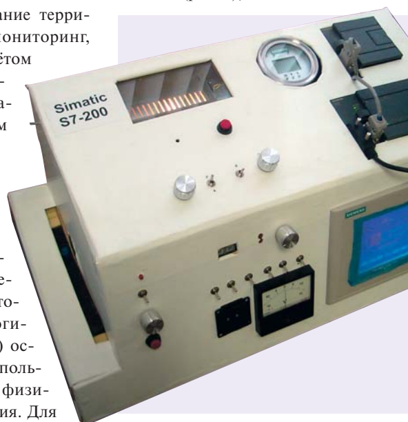
Рис. 9. Лабораторный стенд управления дискретным и непрерывными технологическими процессами на базе контроллера SIMATIC S7-224XP
