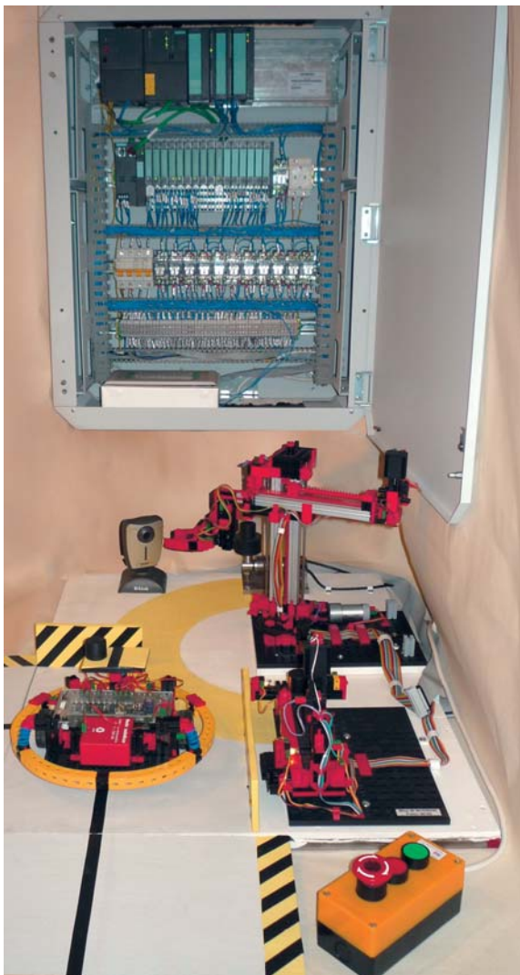
Рис. 10. Модель роботизированного технологического комплекса на основе контроллера SIMATIC S7-315F
