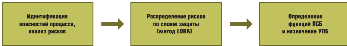
Рис. 2. Схема назначения УПБ функций безопасности ПАЗ
