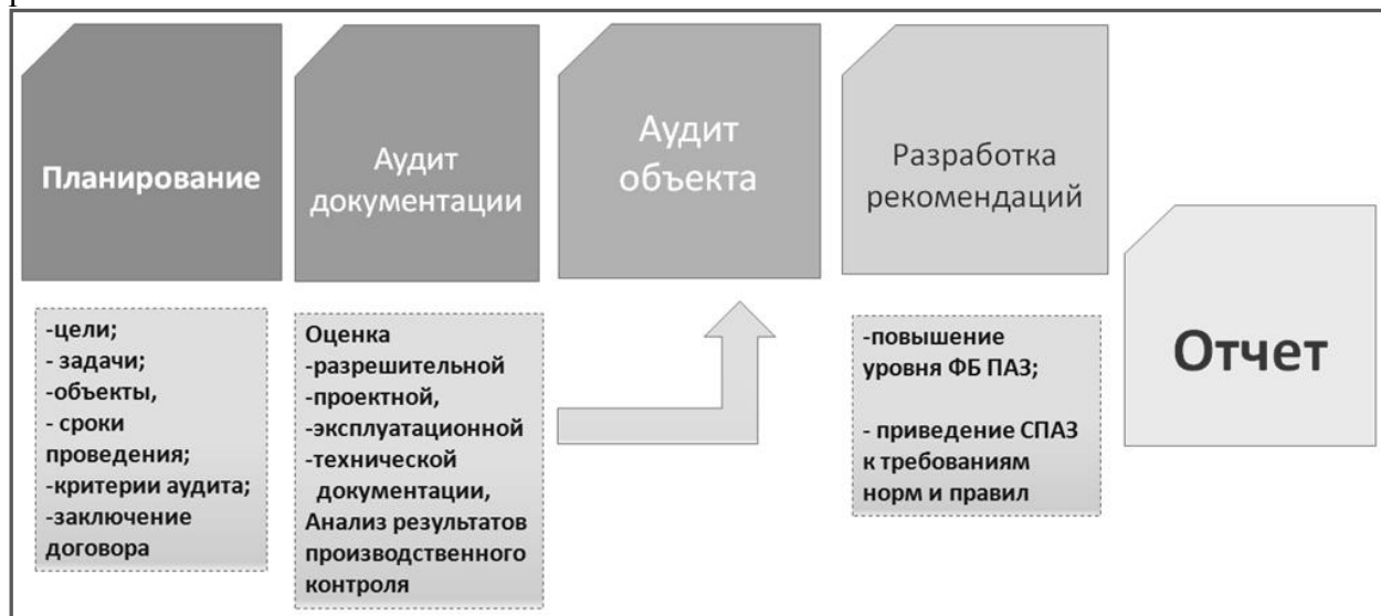
Рисунок 1 – Порядок проведения аудита эксплуатируемых систем ПАЗ
