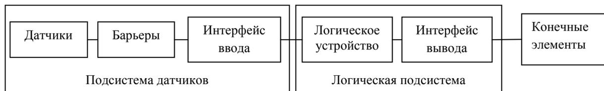
Рисунок 5 – Последовательная структура системы ПАЗ
