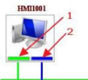
(3) На принципиальной схеме позиция, обозначенная стрелкой 1, показанная зеленым цветом, означает нормальное состояние сети А узла HMI1001; позиция, обозначенная стрелкой 2, показанная синим цветом, означает нормальное состояние сети В узла HMI1001. Серый цвет в позициях 1 и/или 2 означает нарушение подключения к сети А и/или сети В, соответственно. Красный цвет в позициях 1 и/или 2 означает наличие неисправностей в сети А и/или В соответственно.
